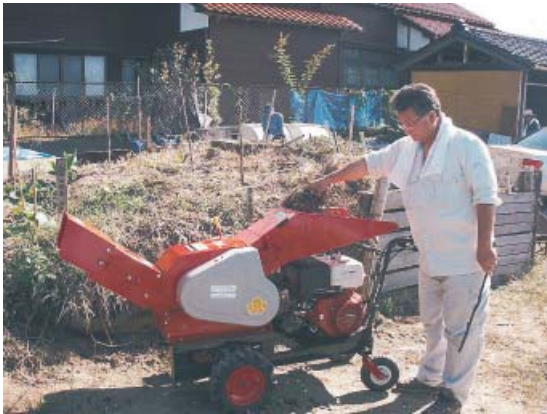
自走式の粉碎機 (セブンイレブンみどりの基金より助成)
