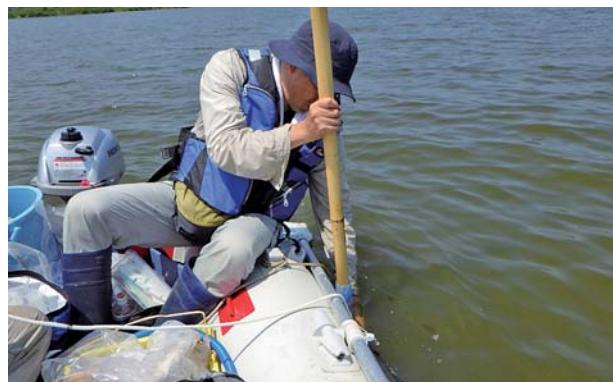
写真4 コアサンプラーを用いて河北潟の底泥を採泥中（8月4日）
