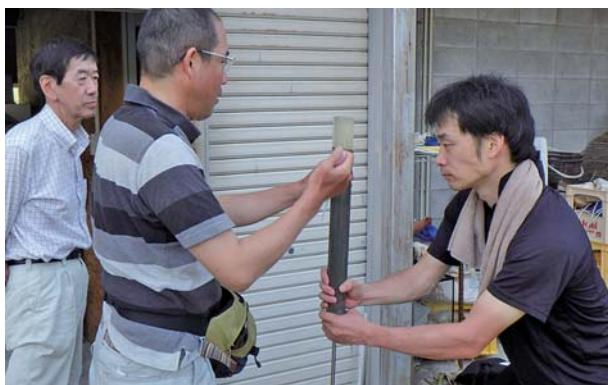
写真7 河北潟で採取した底泥コアを分析用に3 cmづつに切り分けている様子（8月4日）
