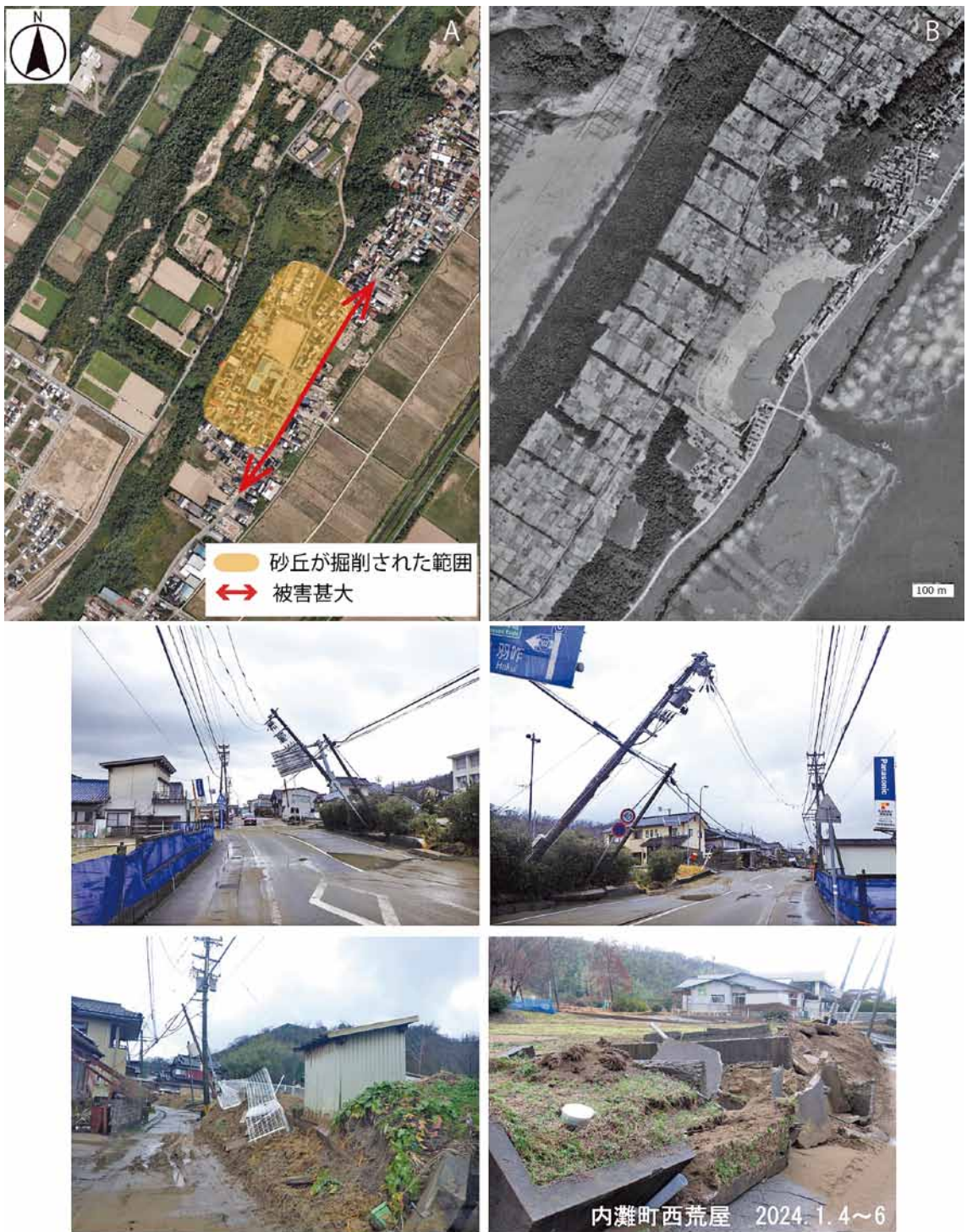
図 3b. 被害が深刻だった内灘町西荒屋の被害状況と、付近の震災前と1960年代の空中写真の比較. 出典: 国土地理院撮影の空中写真 (A: 全国最新写真 (シームレス), B: 年代別空中写真 (1961年-1969年), 2024年3月30日時点).
